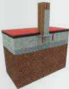
Cada estructura de juego debe estar anclada imperativamente al suelo con un zócalo de hormigón.
