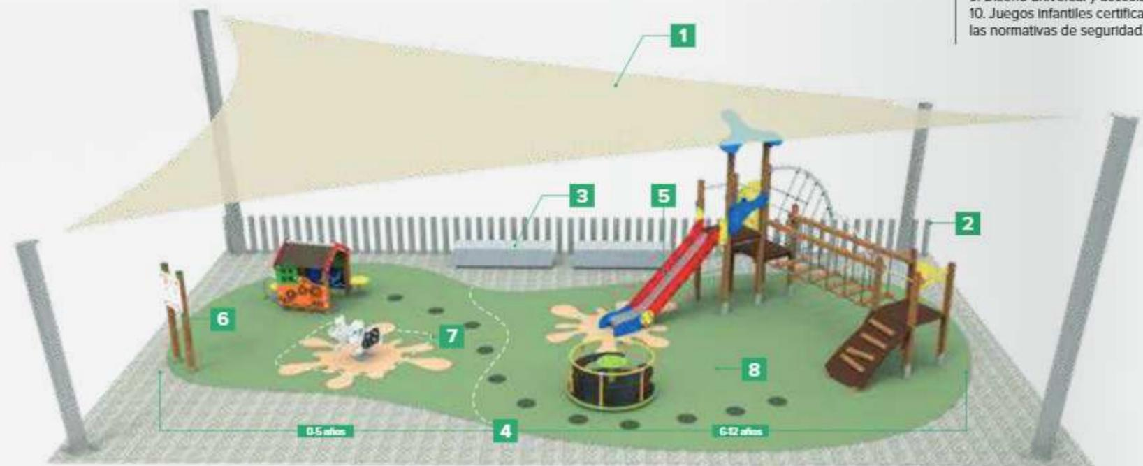
10 POINTS CLES Pour concevoir une aire de jeux. 1. Zones d'ombre. 2. Délimiter l'aire de jeux. 3. Zones de repos. 4. Séparer par tranche d'âge. 5. Tobogans face au nord. 6. Inspections et entretien. 7. Aire de sécurité libre d'obstacles. 8. Matériau antichoc. 9. Design universel et accessibilité. 10. Jeux certifiés conformément aux normes de sécurité.
